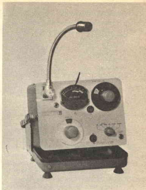
Un analizzatore di rumore a bande di un'ottava permette una rapida analisi armonica del rumore ed è di valido aiuto nell'identificazione e nel trattamento sorgenti separate delle diverse componenti del rumore.
