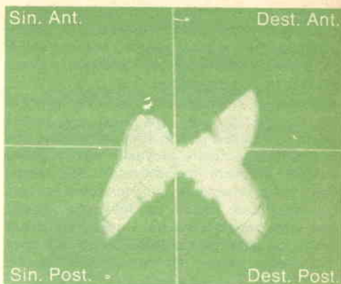
Fig. 1 - La forma a farfalla mostra un forte segnale in tutti i canali salvo che in quello anteriore sinistro; la sfocatura rappresenta modulazione incrociata.
